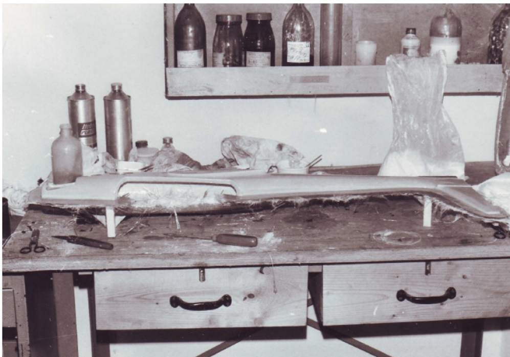
Das war DER Arbeitsplatz in der Werkstatt – Harzraum (hier entsteht ein Motorseglerumpf)
